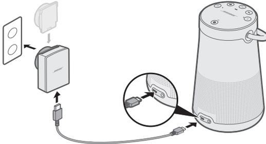
2. Raccordez l'autre extrémité à l'alimentation électrique USB.
